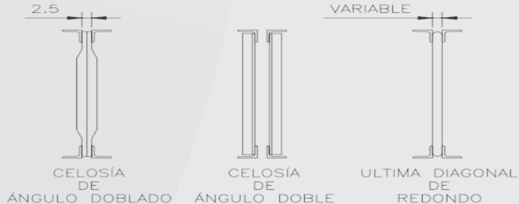
Los joist Longspan pueden ser fabricados para apoyar en la cuerda superior o inferior (extremos en escuadra), además la cuerda superior puede tener una o dos pendientes (Ver configuraciones geométricas). El peralte nominal para joist con pendiente será el peralte al centro del claro, excepto en joist con la cumbrera desfasada del centro, en cuyo caso el peralte se tomará en este punto.
